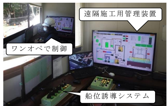
写真－2 管理事務所からの遠隔施工
